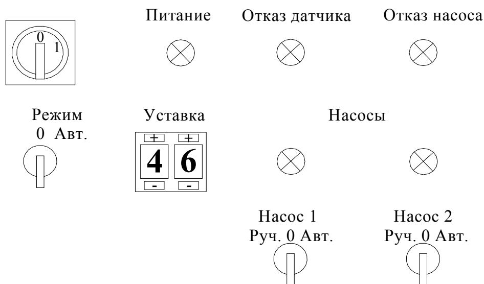
Рис. 3.1. Панель управления и индикации ШУН А
